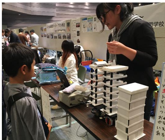
図3 卓上振動台による振動実験
